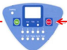
フィルター交換後は正面プレートの**ZERO** ボタンを2秒間長押しをしてください。
